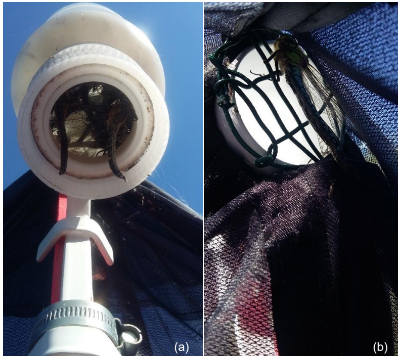
Figure B-3 : Encombrement du dispositif de collecte par des odonates (a) et mise en place d'une grille au niveau du trou du dispositif (b) © E. GAROT (2025)
