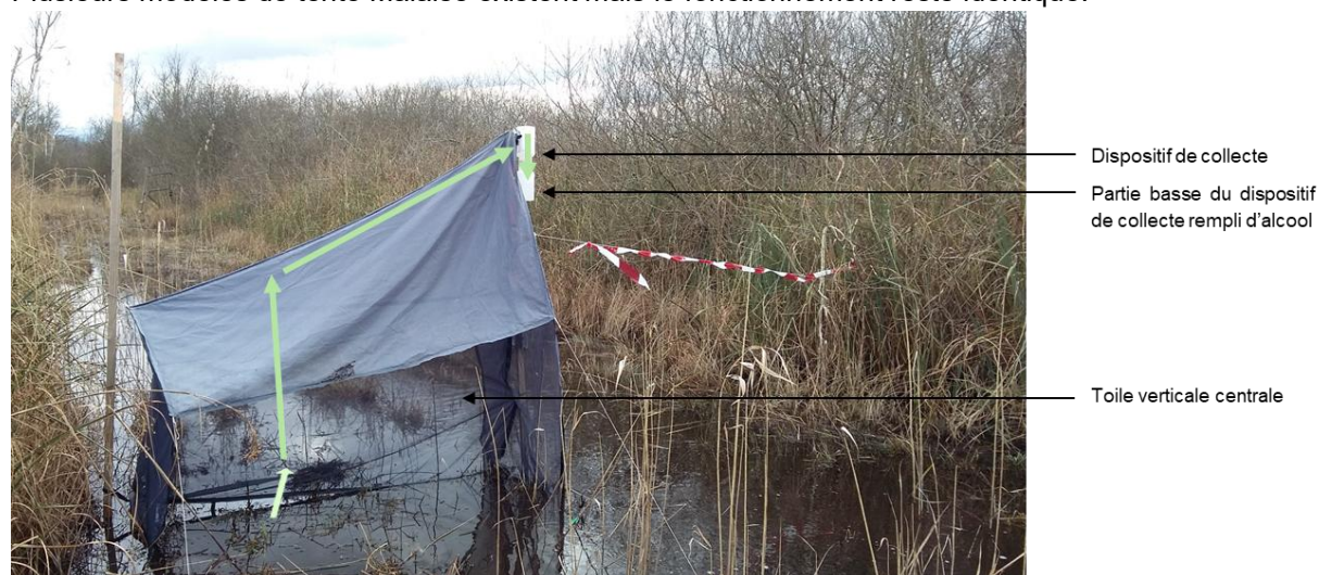
Figure B-1 : Fonctionnement d'une tente Malaise (les flèches vertes représentent le chemin-type d'un insecte intercepté par la tente Malaise pour finir dans le dispositif de collecte) © E. GAROT (2025)
