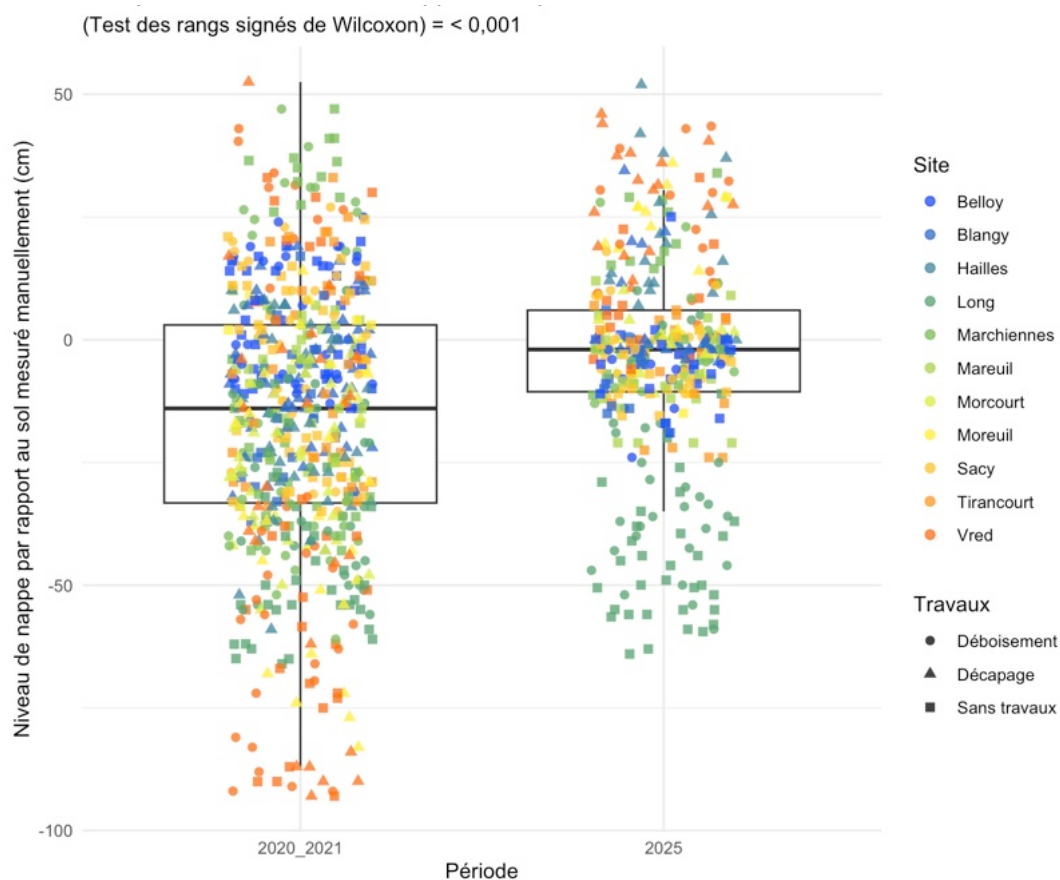
Figure 5 : Comparaison du niveau de nappe entre périodes (2020-2021 et 2025), en fonction des sites et des travaux réalisés.
